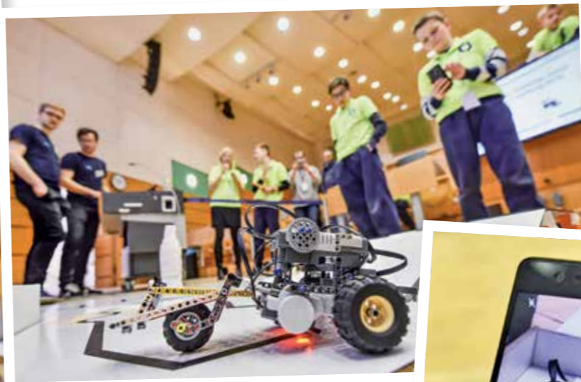
Anspruchsvoll: Die Roboter müssen selbstständig einer vorgegebenen Linie folgen.
